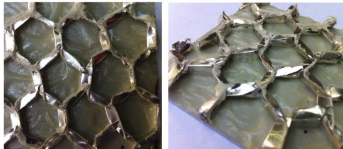
Figure 2.9 : Déformation du nid d'abeille aluminium avec une peau [11].
